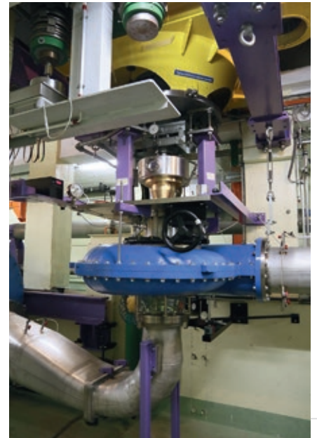
Turbine à bêche spirale sur le stand d'essais Mhylab
